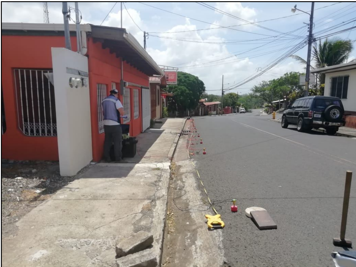
Fotografía 2. Ejecución del ensayo MASW-13.
