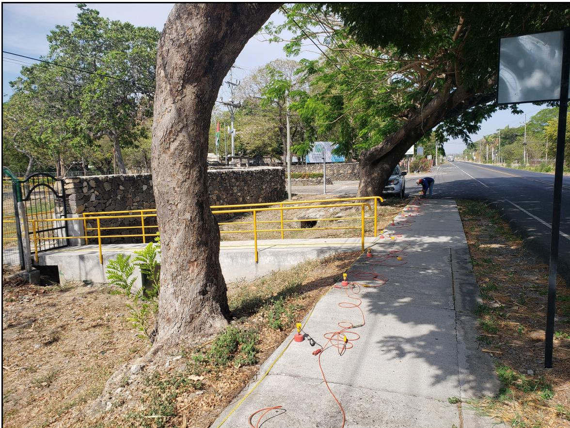
**Fotografía 2. Ejecución del ensayo MASW-12.**
