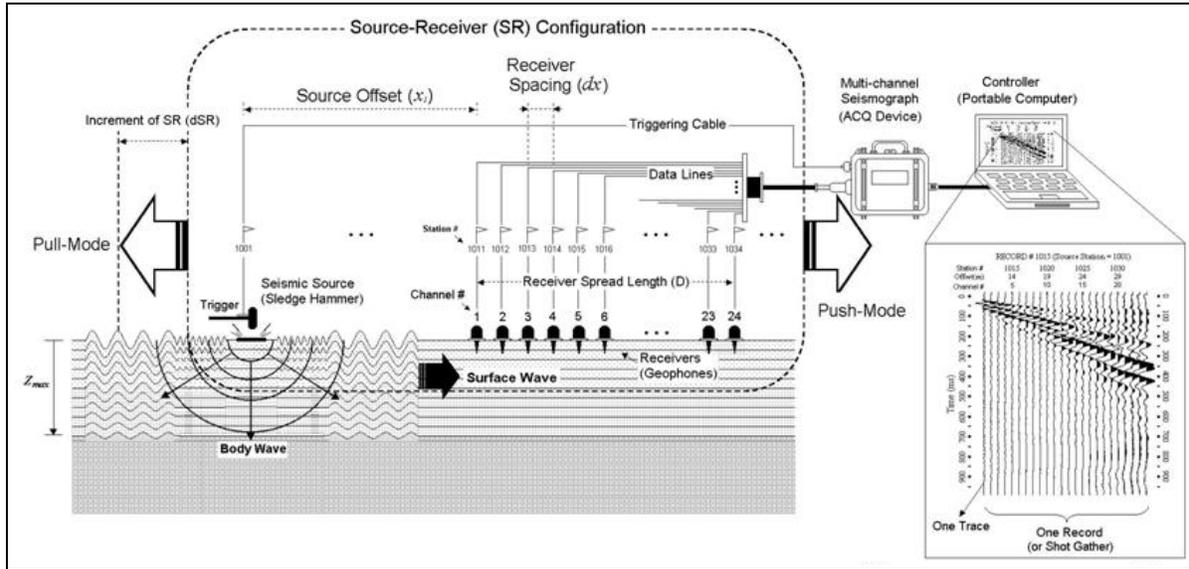
**Figura 2. Diagrama esquemático de ejecución del método MASW.**
