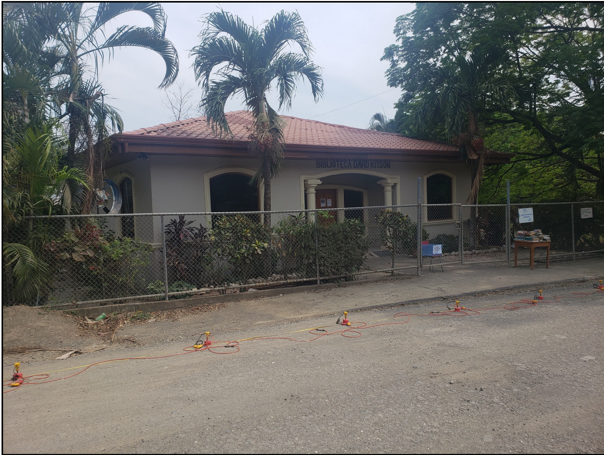
Fotografía 1. Ejecución del ensayo MASW-10.
