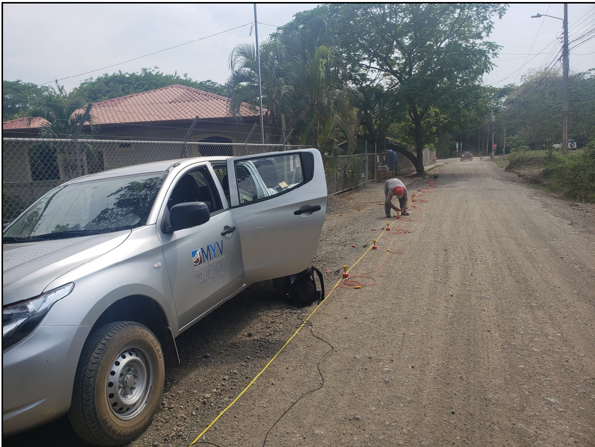
Fotografía 2. Ejecución del ensayo MASW-10.
