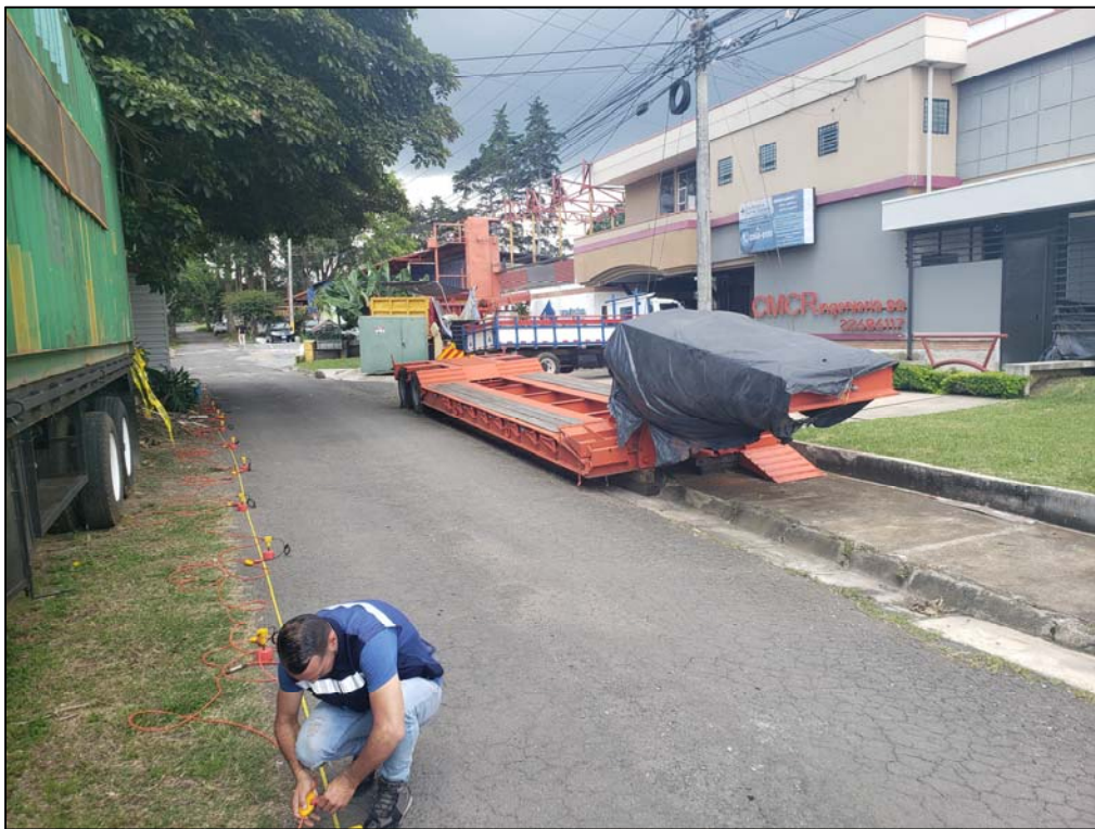
Fotografía 2: Ejecución de ensayo MASW-10
