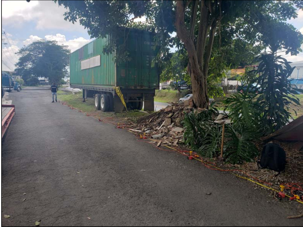
Fotografía 1: Ejecución de ensayo MASW-10
