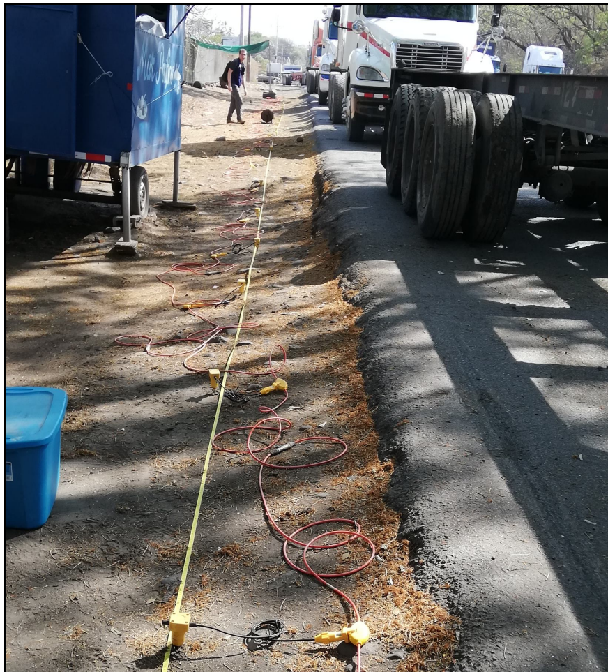
Fotografías 1 y 2. Ejecución del ensayo MASW-6.
