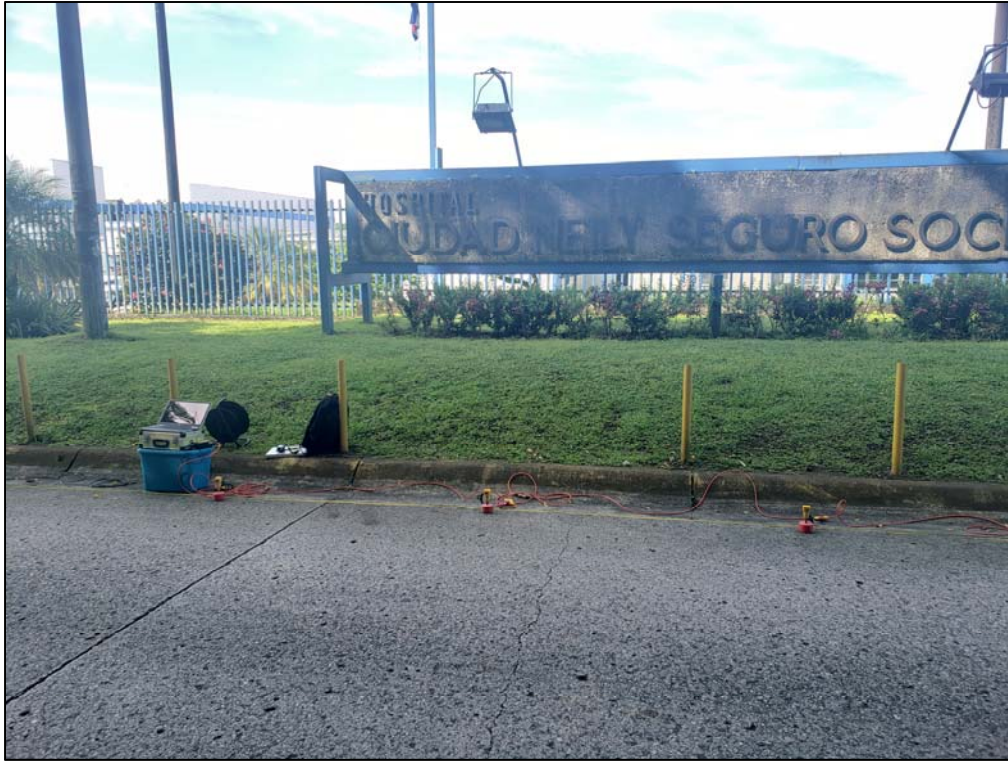
Fotografía 1: Ejecución de ensayo MASW-4
