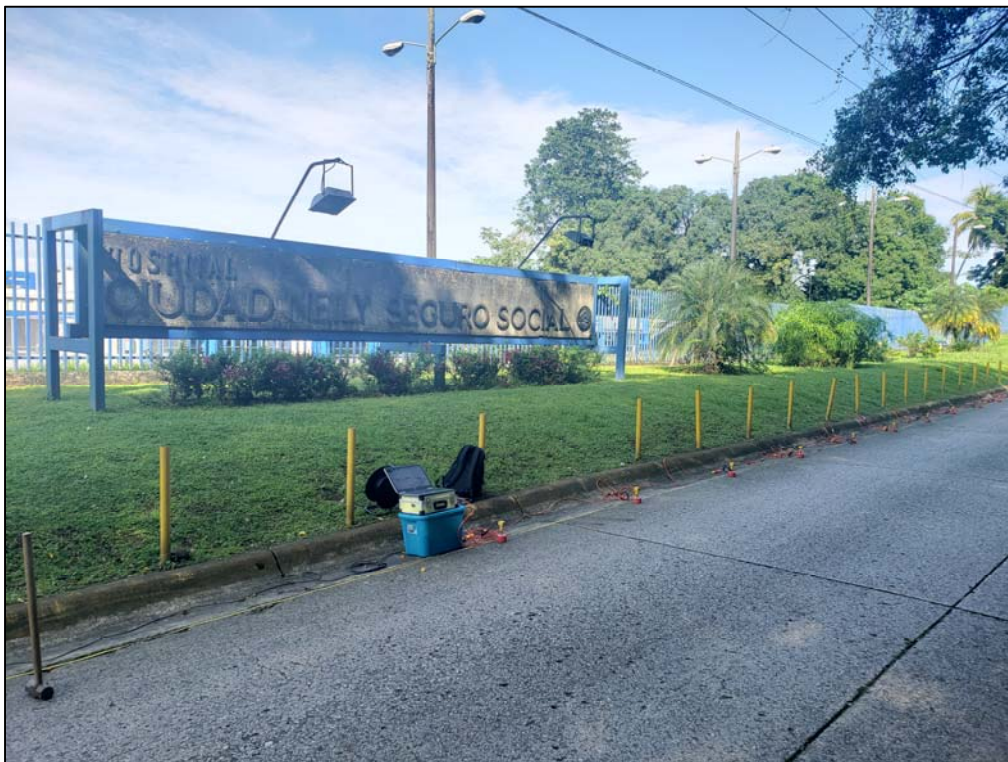
Fotografía 2: Ejecución de ensayo MASW-4
