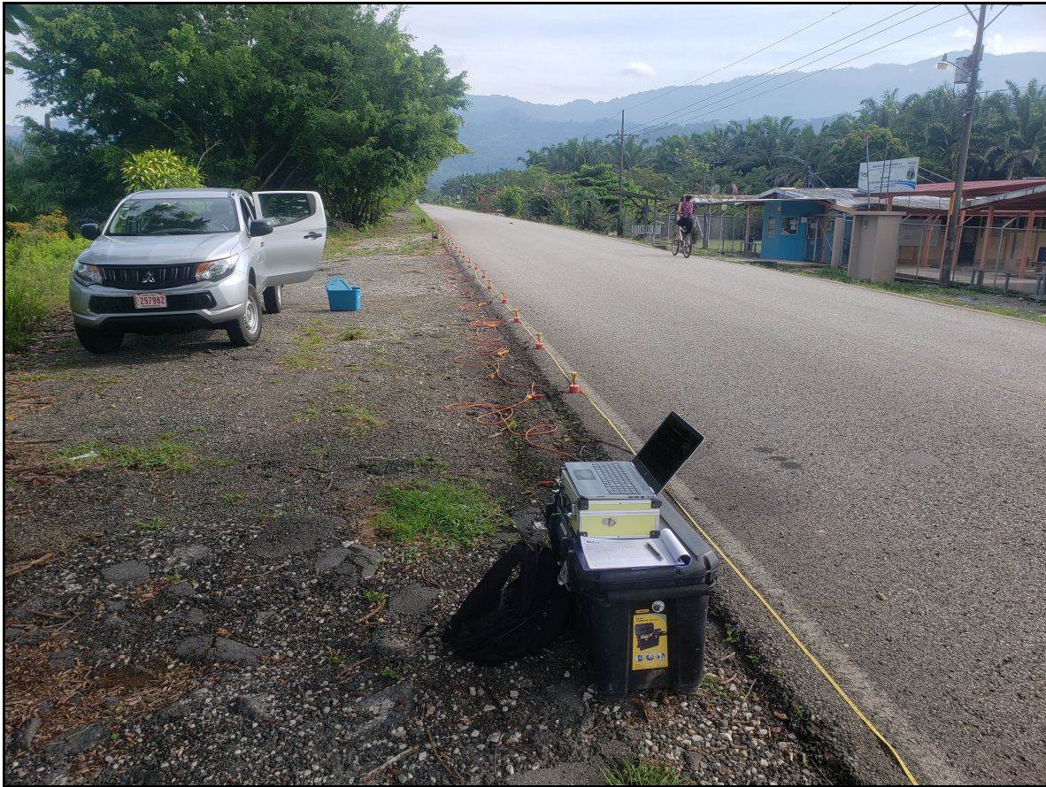
Fotografía 1. Ejecución del ensayo MASW-2.
