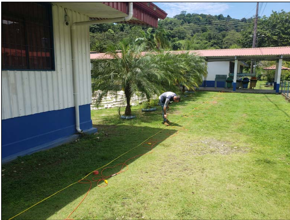
Fotografía 2: Ejecución de ensayo MASW-6
