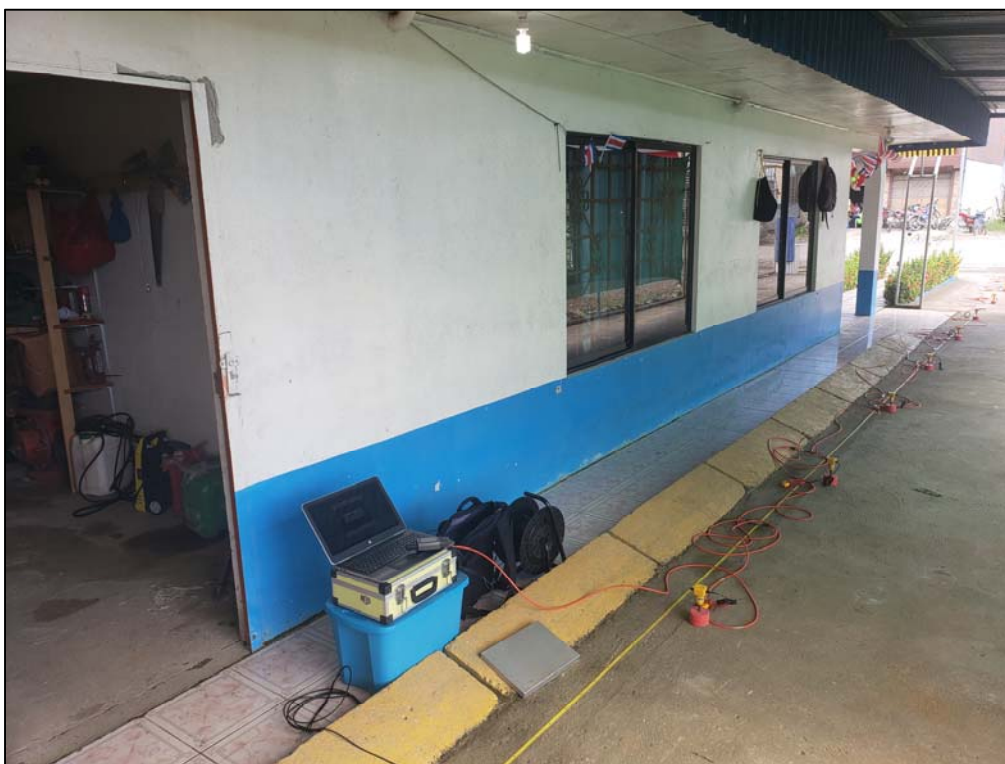
Fotografía 2: Ejecución de ensayo MASW-7
