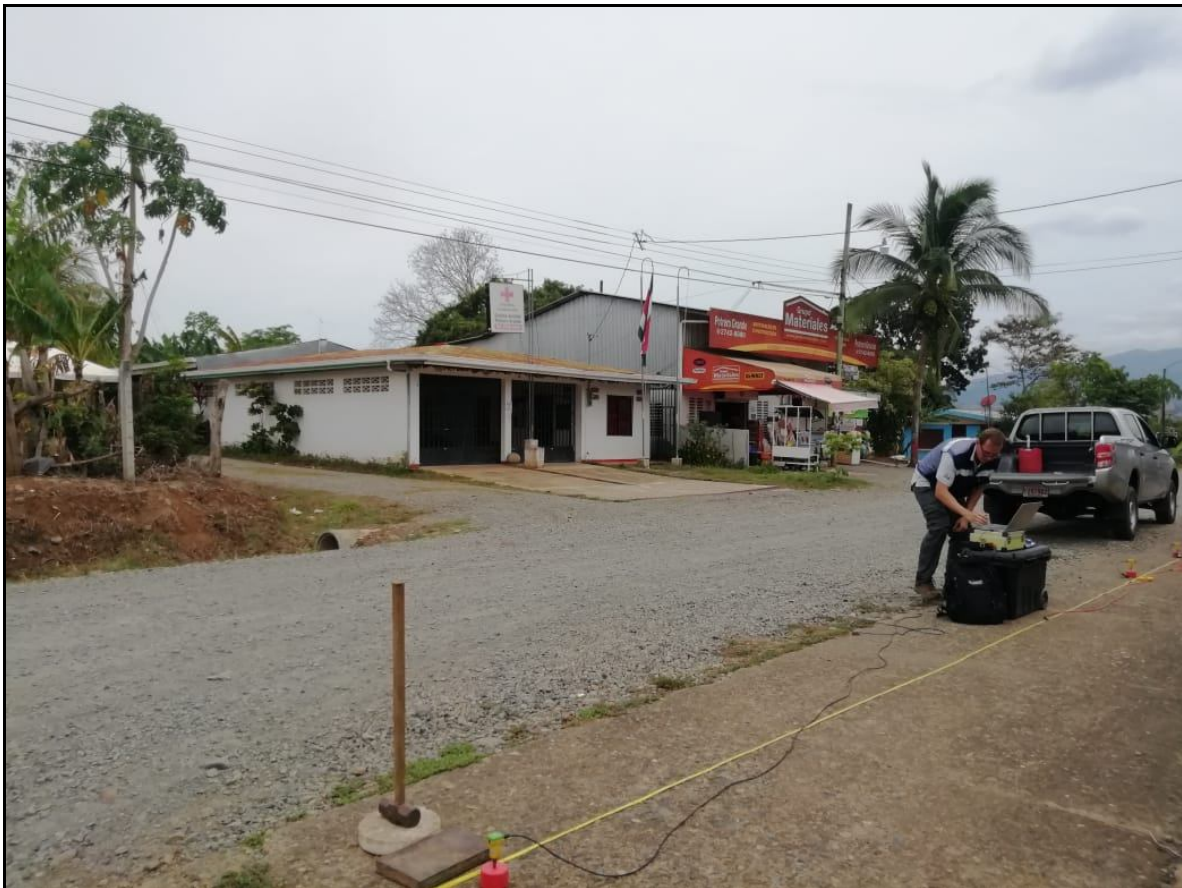
Fotografía 2. Ejecución del ensayo MASW-4.
