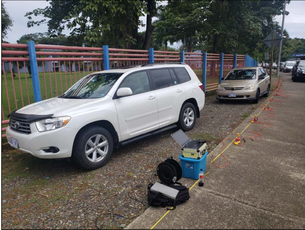
Fotografía 1: Ejecución de ensayo MASW-2
