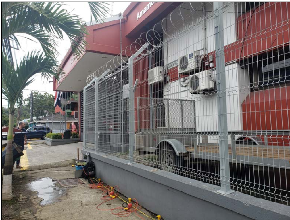
Fotografía 2: Ejecución de ensayo MASW-1
