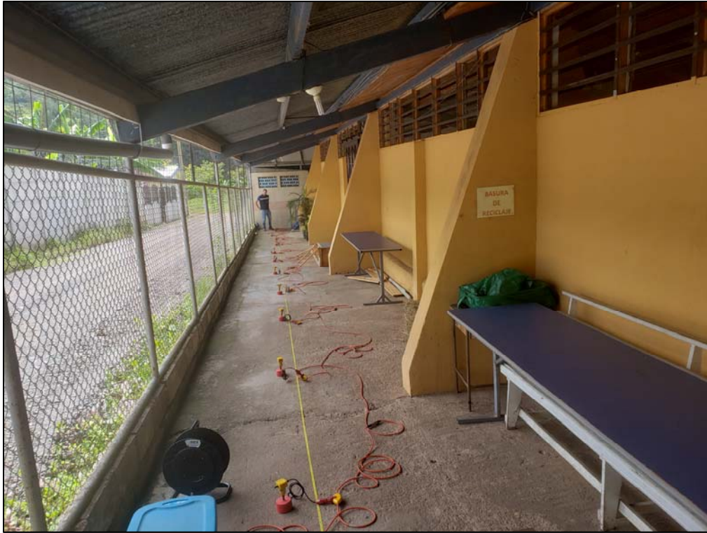
Fotografía 1: Ejecución de ensayo MASW-8
